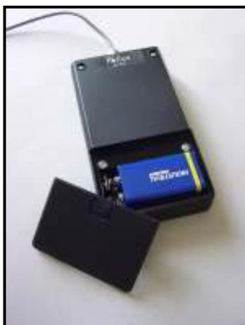
Un couvercle au dos permet d'accéder facilement à la pile 9V (type 6F22; PP63; 6LR61). Le sens de la pile est automatiquement détecté.
